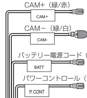
マルチビュー車載カメラCMOS-320 (別売品) のコントロール端子へ接続します。接続しない場合はキャップを外さないでください。
